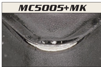
MC5005+MK 摩耗量 0.29mm 加工数 30 台
