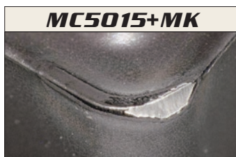
MC5015+MK 摩耗量 0.44mm 加工数 17 台
