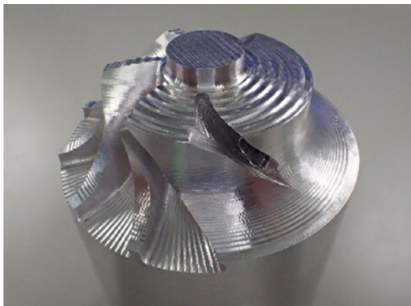
溝加工時に折損
