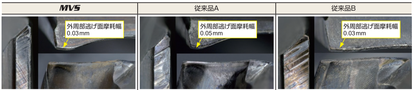
切削長55m加工時の刃先損傷状態
