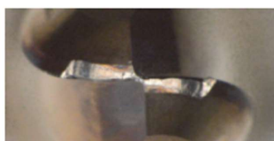
他社高硬度用 摩耗幅0.163mm
