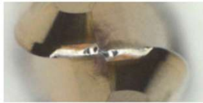
他社高硬度用 摩耗幅0.1mm
