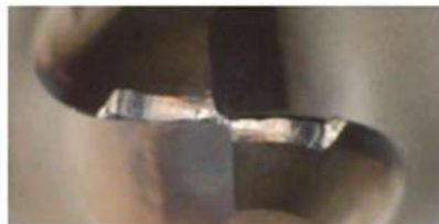
他社高硬度用 摩耗幅0.163mm
