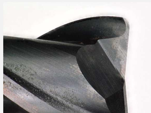
荒取り工具の摩耗状態 DHR237R \phi 3 \times R0.2 \times 12
