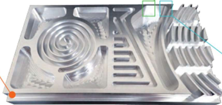
コーナ部のびびり無し No chattering at corner
